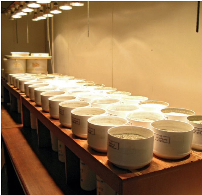
Fig. 2. Long-term kinetic leach columns to establish water quality characteristics of tailings from the Grasberg Cu-Au mine, Indonesia. Bild 2. Langfristige kinetische Elutionssäulen zur Feststellung der Wasserqualität von Flotationsschlämmen aus der Grasberg Kupfer-Goldmine, Indonesien. Photo/Foto: Lottermoser
